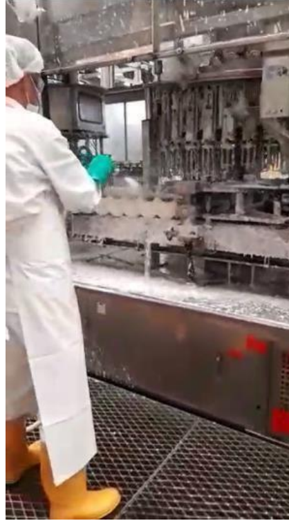
Figura 7: Saneamiento llenadora de PET
