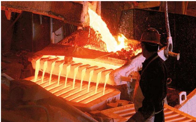
Fig.19 Muestra el cobre liquido siendo fundido sobre moldes. [39]
