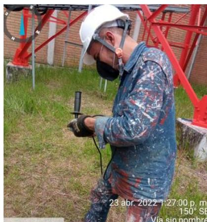
*Ilustración 9.* Inspección de Equipo: Se realiza inspección de pulidora que se encuentre en buen estado se verifica que tenga todas sus partes y cuente con el guarda discos y la manija de sujeción
