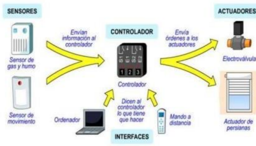
Figura 3. Diagrama de Funcionamiento general de la domótica
