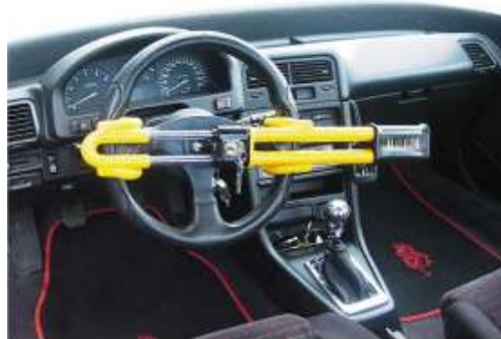
Figura 13: Barra antirrobo para inmovilizar el vehículo, Fuente: http://www.leibat.net/barras-antirrobo-c-1240_3779.html
