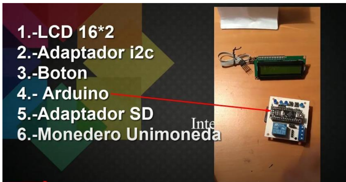
Ilustración 4.Elementos internos del WIFI-SHARE
