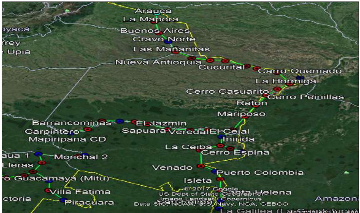
Figura 7: troncal de radio enlace en zona oriente del país del proyecto PNCAV. Imagen tomada y modificada desde [5].
