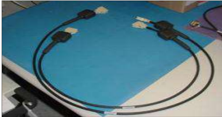
Figura 23: cable bus, imagen tomada y modificada desde [4].
