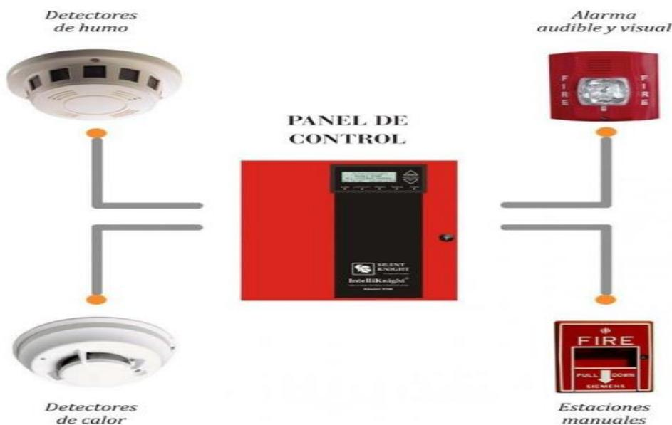
*Ilustración II Diagrama sistema de detección de incendio
