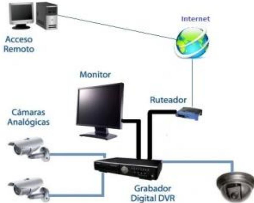
Ilustración IV Diagrama de sistema CCTV
