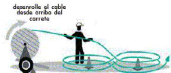
Figura 10. Posición correcta para desenrollar el cable óptico [18]
