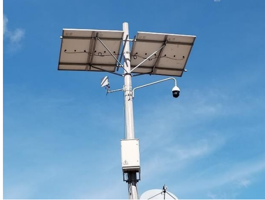
Figura 2.2 Fotografía cámara de vigilancia PTZ con antena transmisora, autor Kevin Gonzalez año 2022 vía Bogotá-la mesa.
