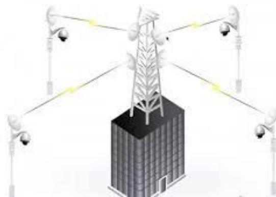
Figura 2.1 Radio enlace punto a multipunto basado en tecnologías para video vigilancia Tomado de https://www.tecnoseguro.com/analisis/pro/radioenlaces-cctv-ip-soluciones-punto-multipunto
